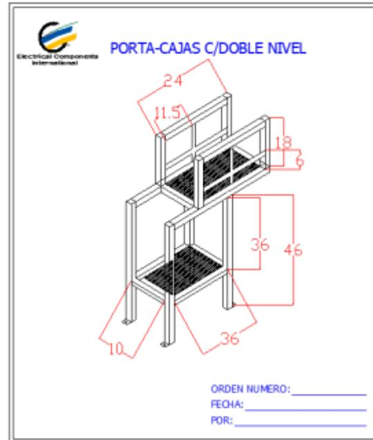
Figura 22. Porta cajas doble nivel para colocar material.
