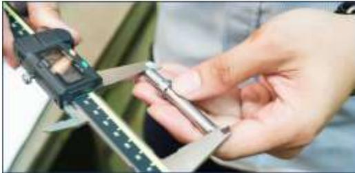
**Figura 2.** Inspección de una pieza con vernier digital.
