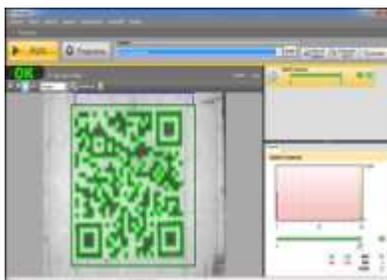
**Figura 21.** *Inspección de pieza maestra detectada como buena “OK”.*
