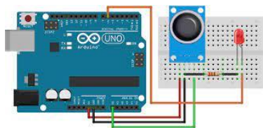
Figura 4 Arduino 1 y sensor Mq2 conectados Fuente: Elaboración propia
