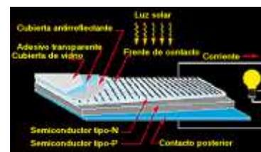
*Figura 1. Partes que conforman una celda fotovoltaica [8]*
