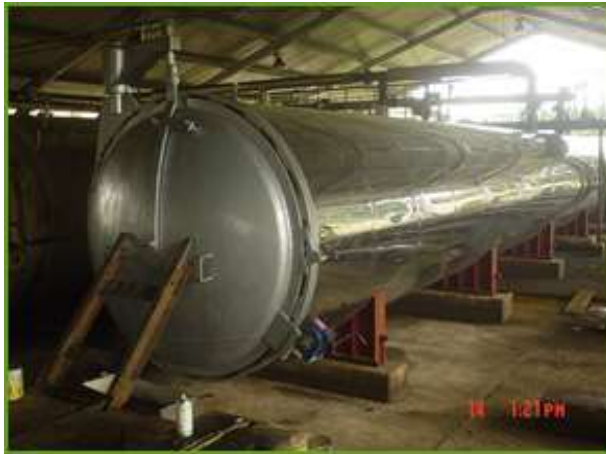
Figura 8. Esterilizador de la planta de aceite. Elaboración Propia Empresa Oleofinos del Carmen Noviembre 2016.
