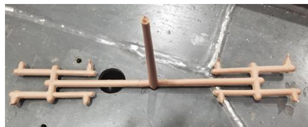
Figura 3. Material de pérdida al decavitar
