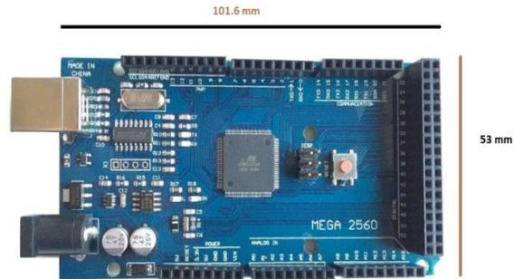
Figura 2. Arduino mega 2560.
